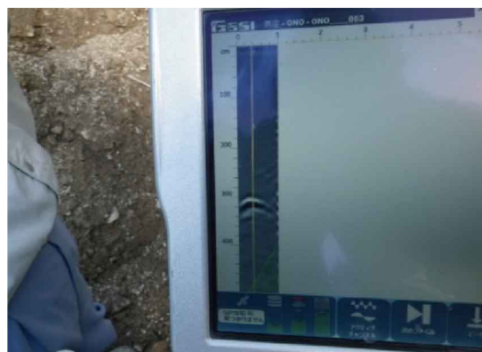
リアルタイムで埋設管の位置を確認
